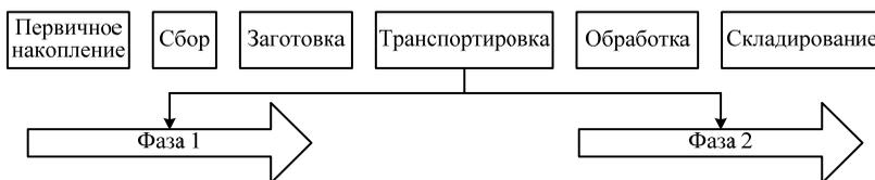
**Рис. 22.** Последовательность технологических операций по преобразованию отходов во вторичное сырье
