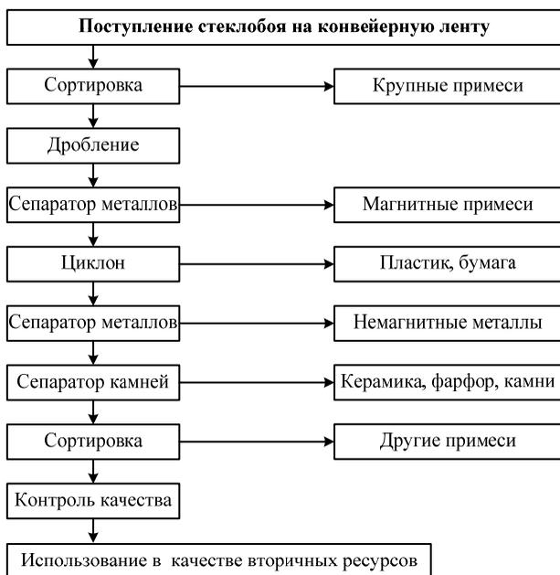
Рис. 39. Технологическая схема переработки стеклобоя [2, с. 6]
