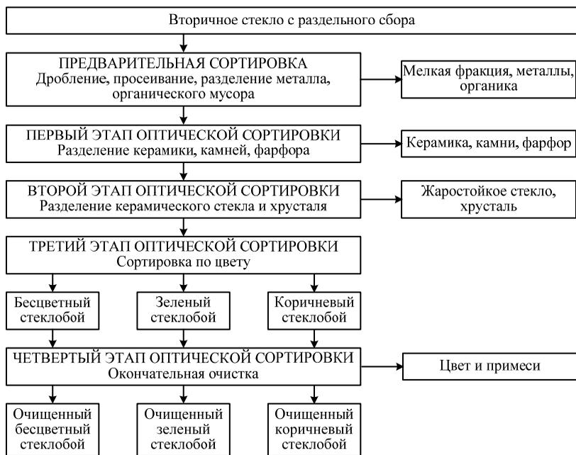
**Рис. 40.** Технологический процесс сортировки стеклобой [65, с. 6]
