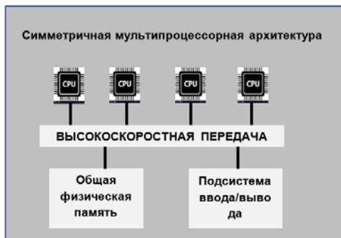
Рис. 1. SMP-архитектура
