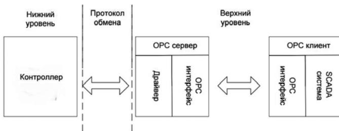
Схема взаимодействия с оборудованием через OPC-сервер
