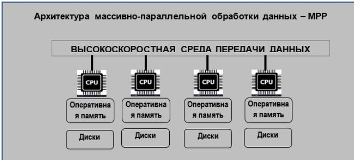
**Рис. 2.** MPP-архитектура
