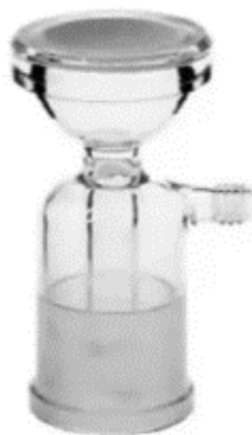
Рис. 3. Фильтрующий элемента с впаянным стеклянным фильтром
