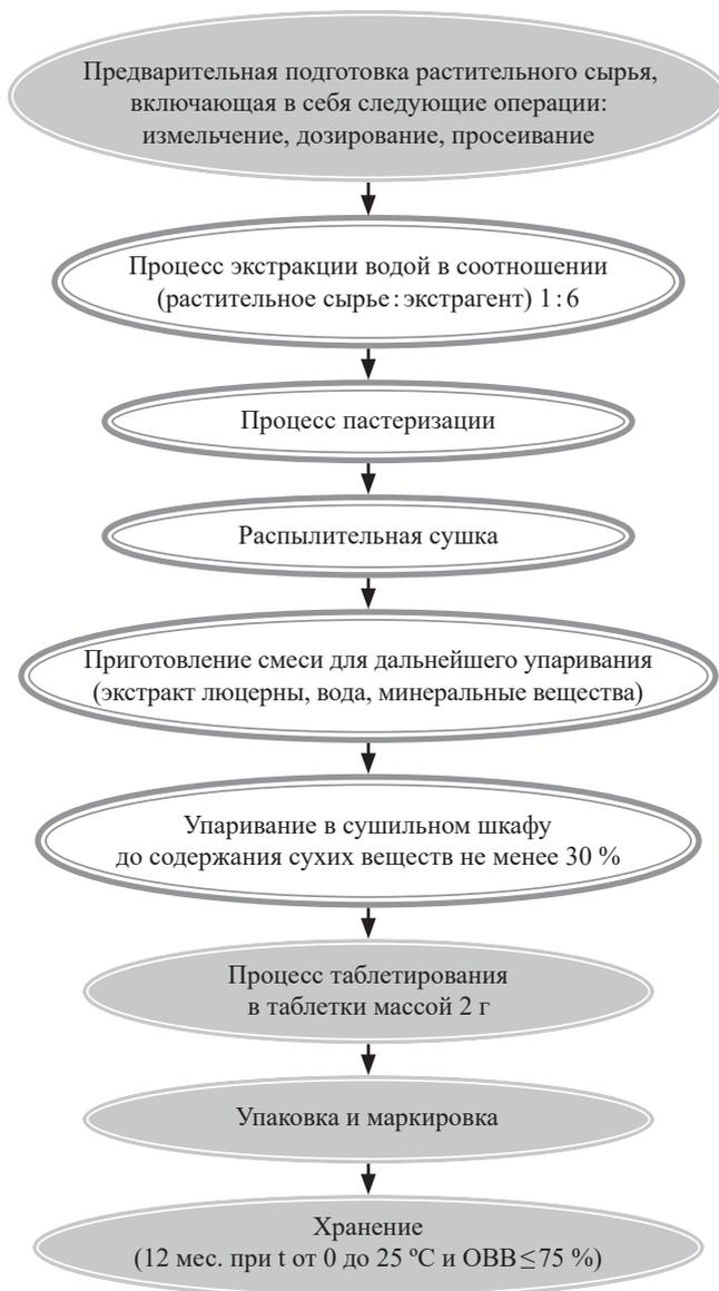
Рис. 1. Технологическая схема БАД «Пользавит»
