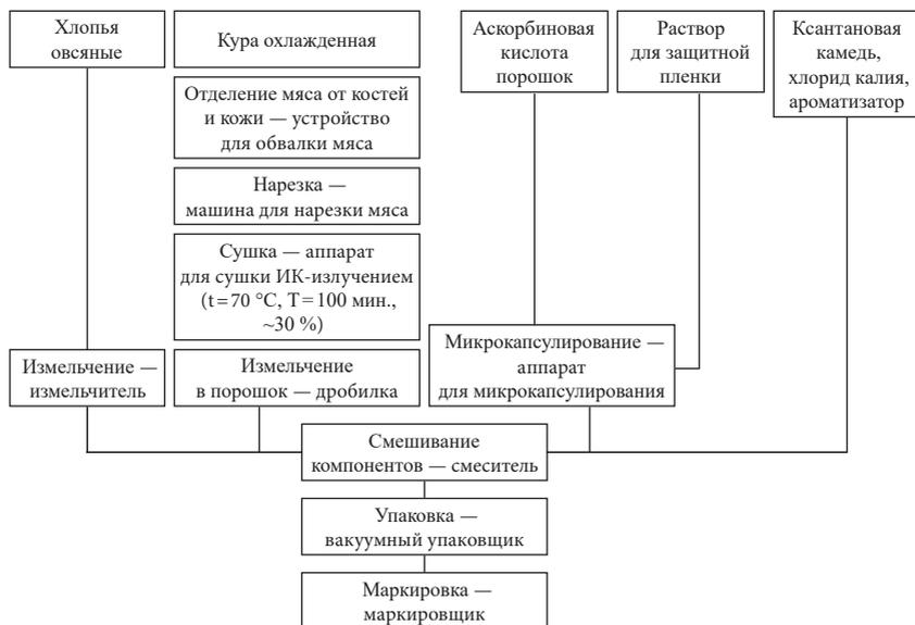
Рис. 2. Схема приготовления пищевого концентрата
