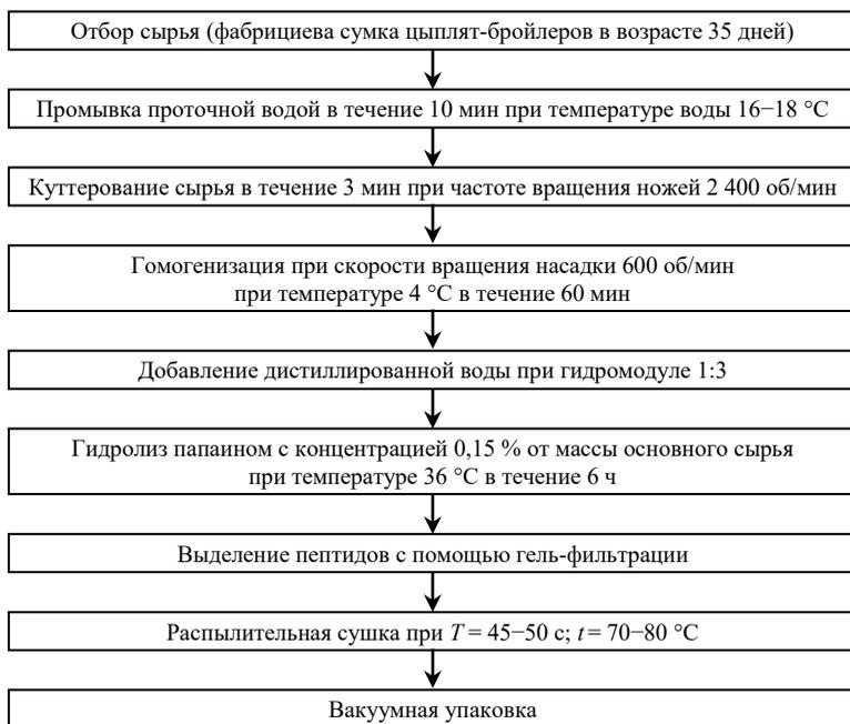
Технологическая схема производства ФГФСЦБ
