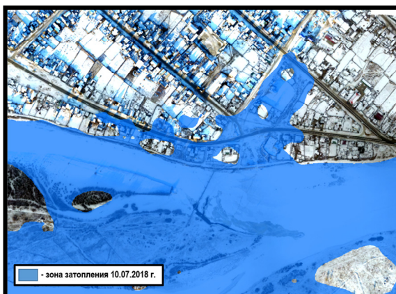
Рис. 5. Зона затопления высокой детальности, построенная для условий реального наводнения р. Нерча, г. Нерчинск (10 июля 2018 г.)
