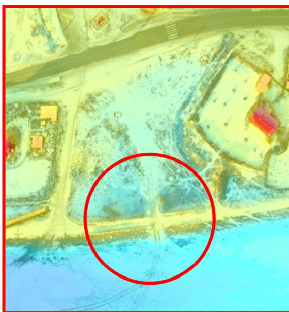
Рис. 6. Причина затопления жилых домов в г. Нерчинск во время наводнения 2018 г., определенная по высокдетальной модели (провал в защитной дамбе из-за переезда автомобилями)
