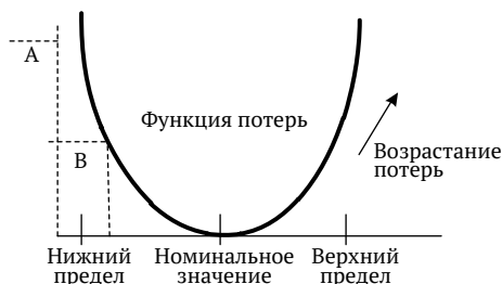
Рис. 1. Функция потерь Тагути при отклонении параметров управления от оптимального значения
