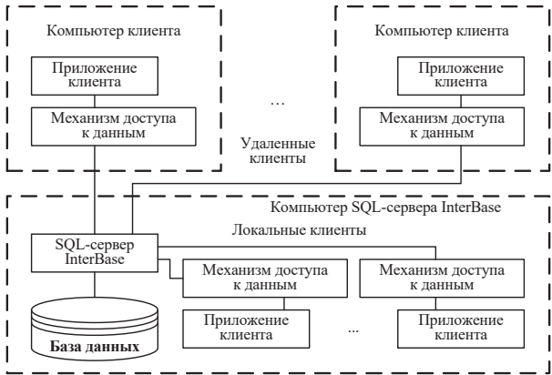
Рис. 1. Схема взаимосвязи проекта и SQL-сервера InterBase
