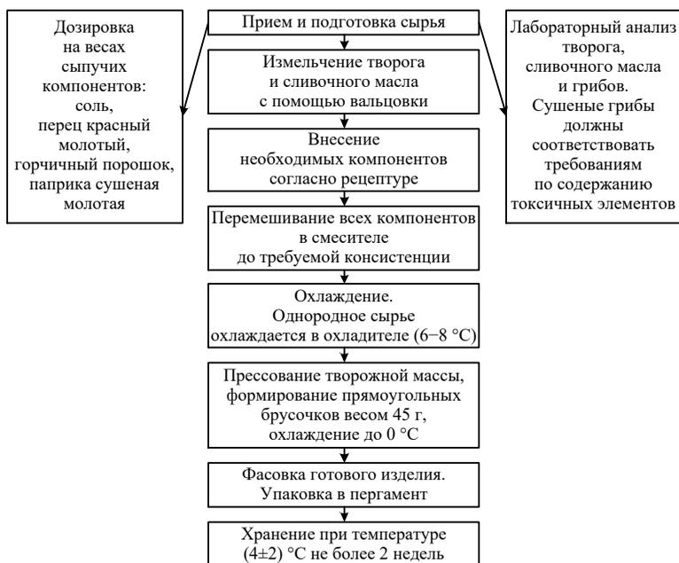
**Рис. 1.** Технологическая схема производства сырков творожных по инновационной технологии
