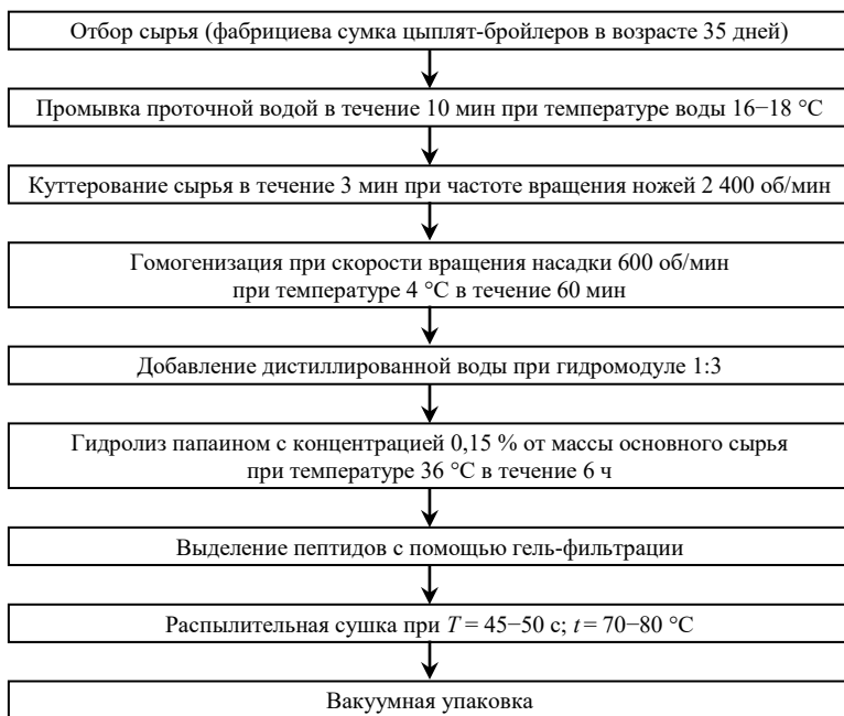
Технологическая схема производства ФГФСЦБ и выделения пептидов с молекулярной массой от 27 до 18 кДа
