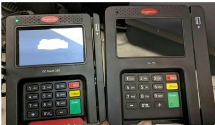
**Рис. 2.** Скиммер (справа) на платежный терминал Ingenico
