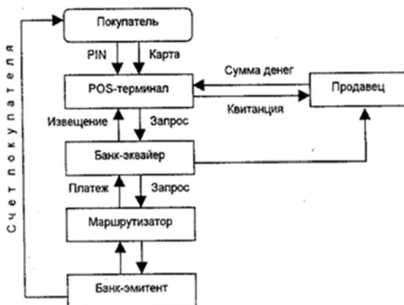
Рис. 1. Схема работы POS-системы при проведении транзакции
