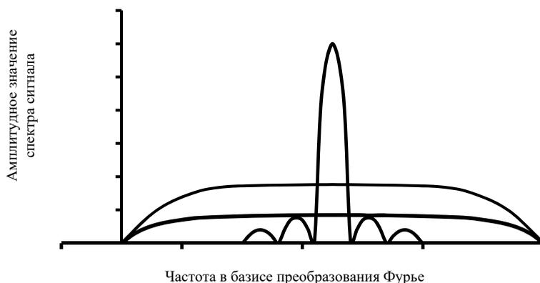
**Рис. 1.** Амплитудные спектры узкополосного и широкополосного сигналов в базисе преобразований Фурье
