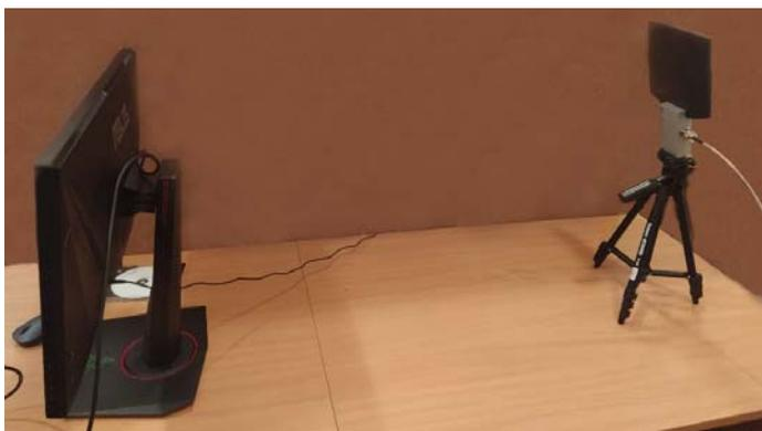
**Рис. 2.** Измерение информативного сигнала на расстоянии 1 м от монитора
