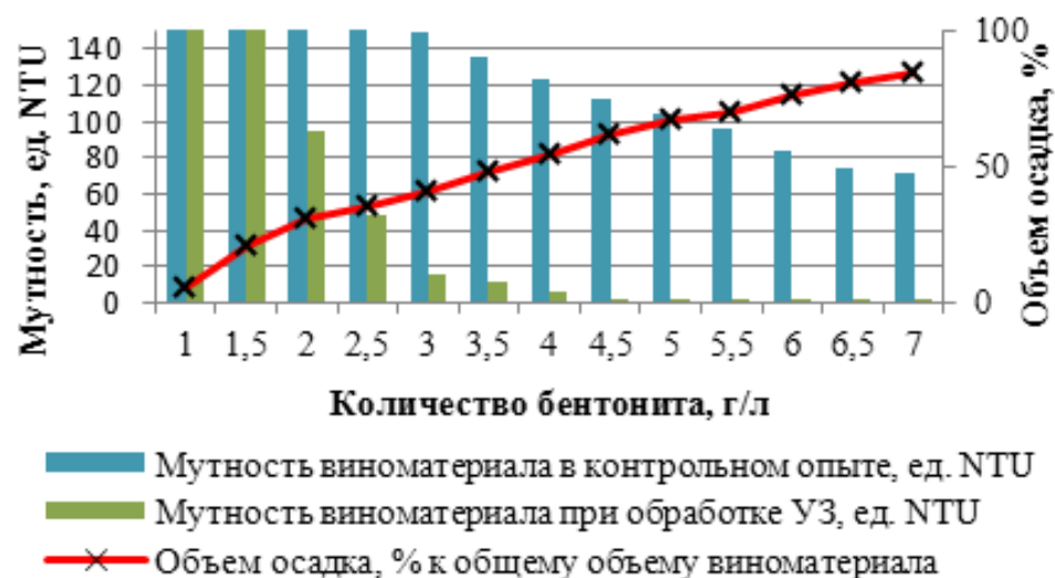
Рисунок 20 – Динамика осветления и объем образующегося осадка в зависимости от концентрации бентонита при ультразвуковой обработке осветляемого виноматериала
