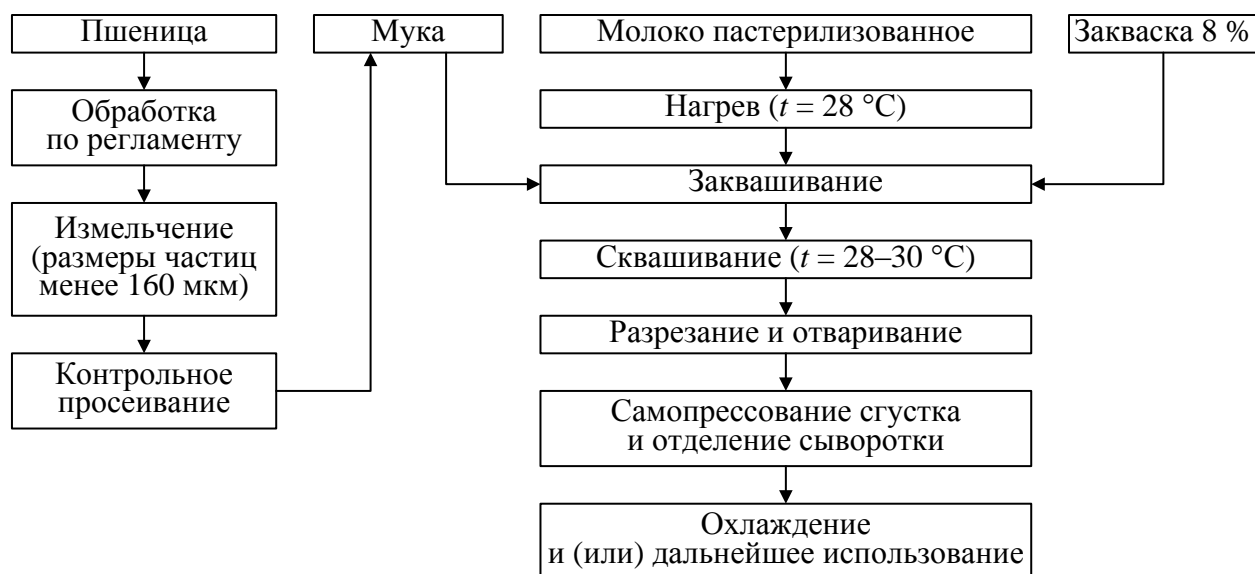
Рисунок 110 – Принципиальная схема получения творожного продукта с пшеничным ингредиентом
