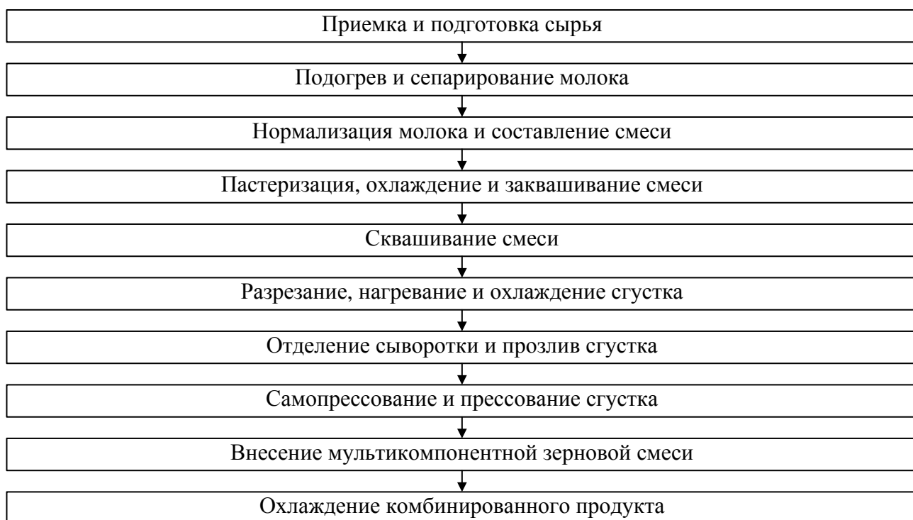
Рисунок 94 – Схема технологического процесса получения творога комбинированного с мультикомпонентной зерновой смесью
