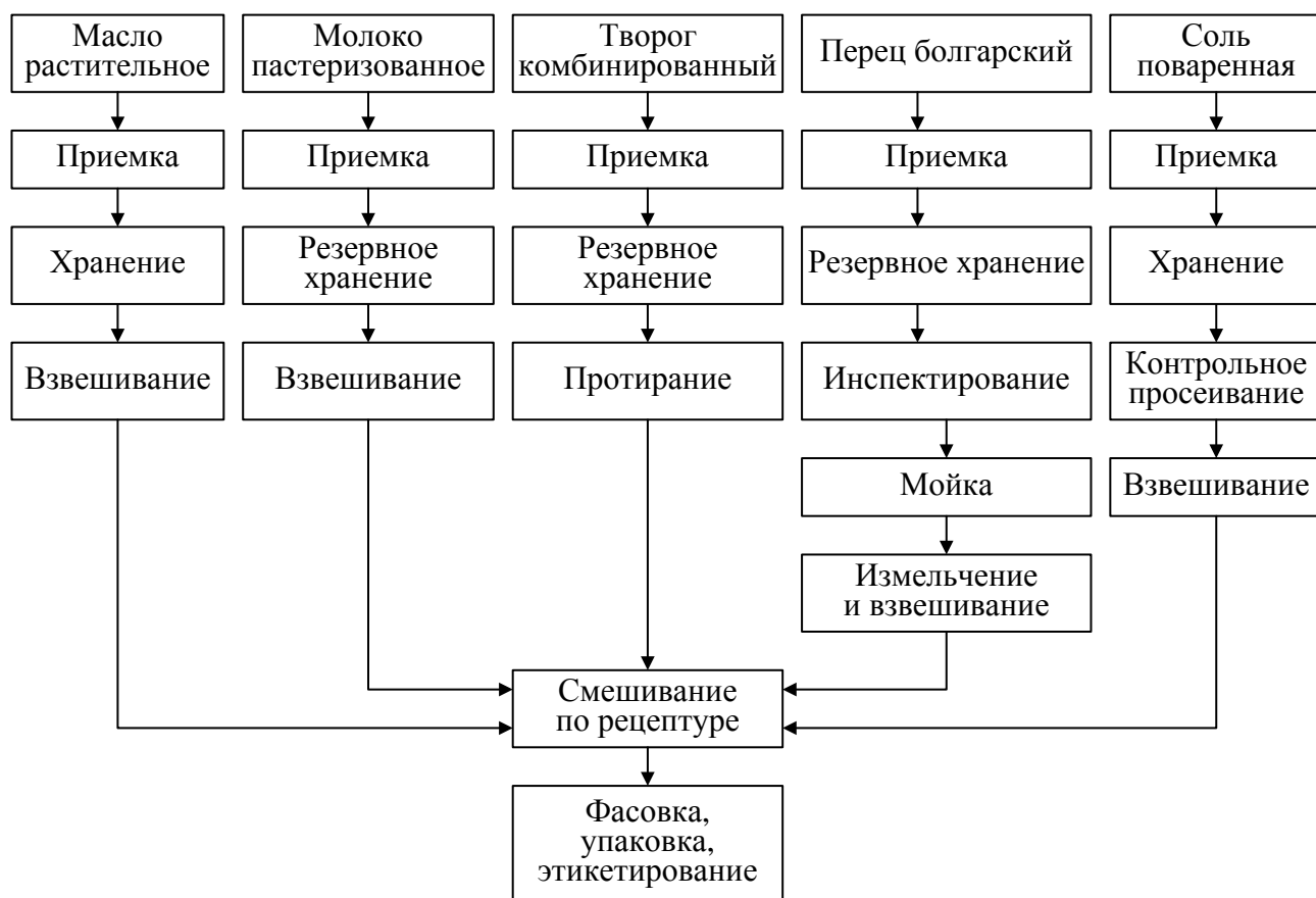
Рисунок 97 – Технологическая схема производства соуса творожного с болгарским перцем
