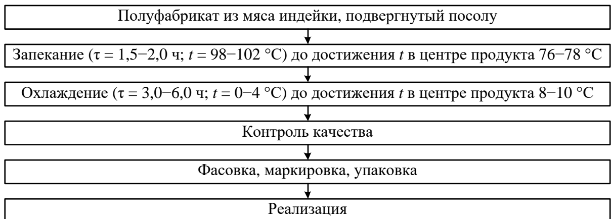
Рисунок 28 – Принципиальная схема технологического процесса изготовления запеченного продукта из полуфабриката из мяса индейки, подвергнутого посолу
