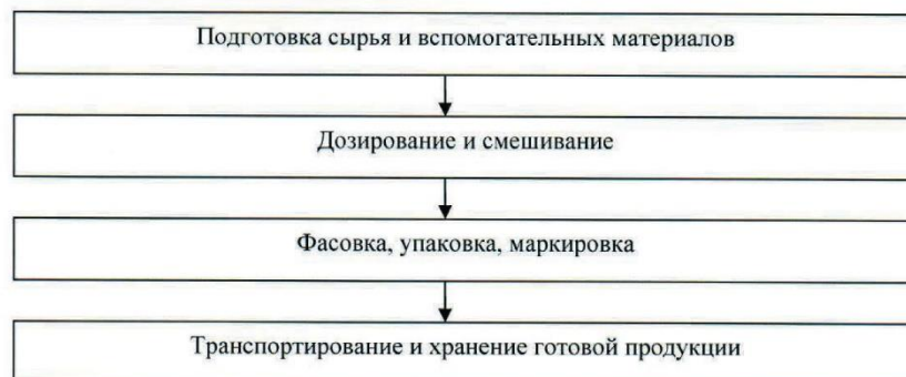
Рисунок 1 – Принципиальная технологическая схема производства полуфабриката на основе зародышей пшеницы
