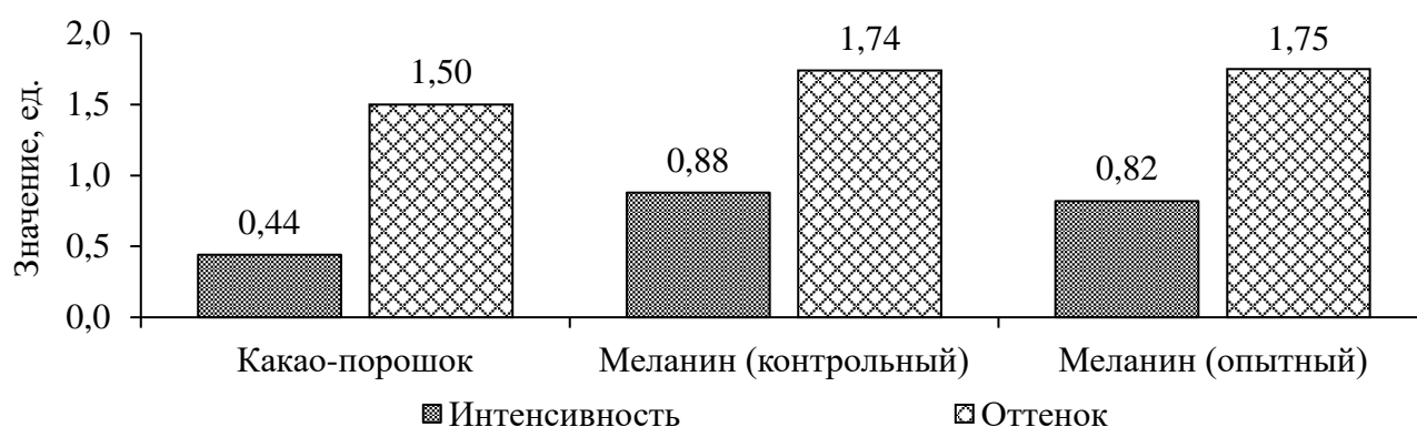
Рисунок 19 – Оптическая плотность образцов какао-порошка, опытного и контрольного меланина из лузги гречихи ( M, n = 3 )
