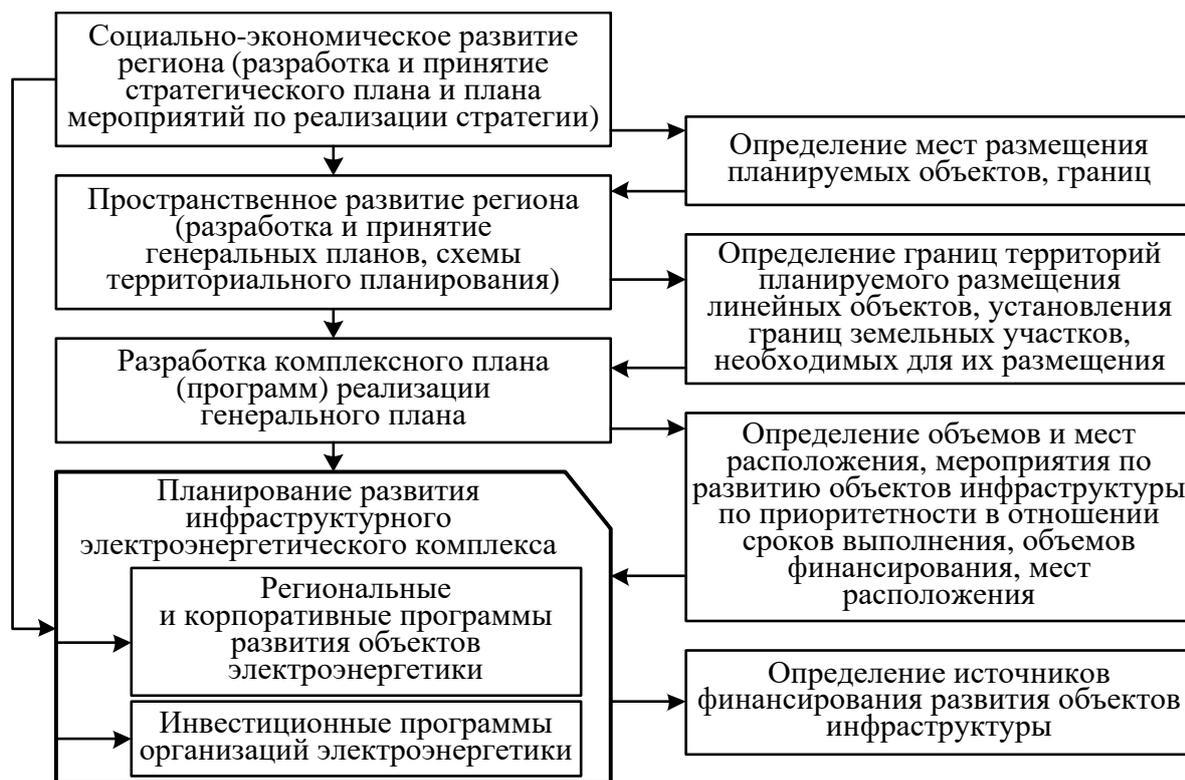
Рисунок 5 – Последовательность разработки документов и параметров стратегического планирования развития региона и инфраструктурного электроэнергетического комплекса
