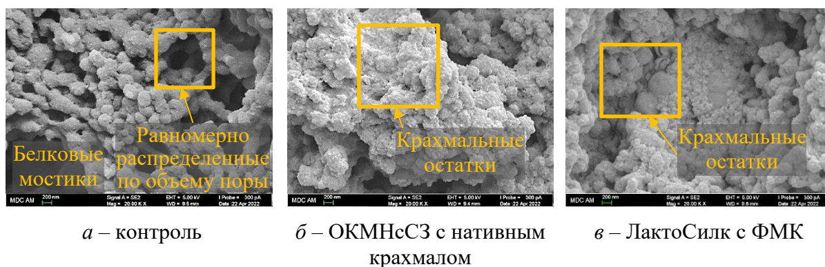
Рисунок 15 – Микроструктура ОКМНсСЗ (7 сут) ( \times 20\,000 )
