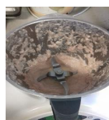
Измельчение в куттере, 1200 об/мин
