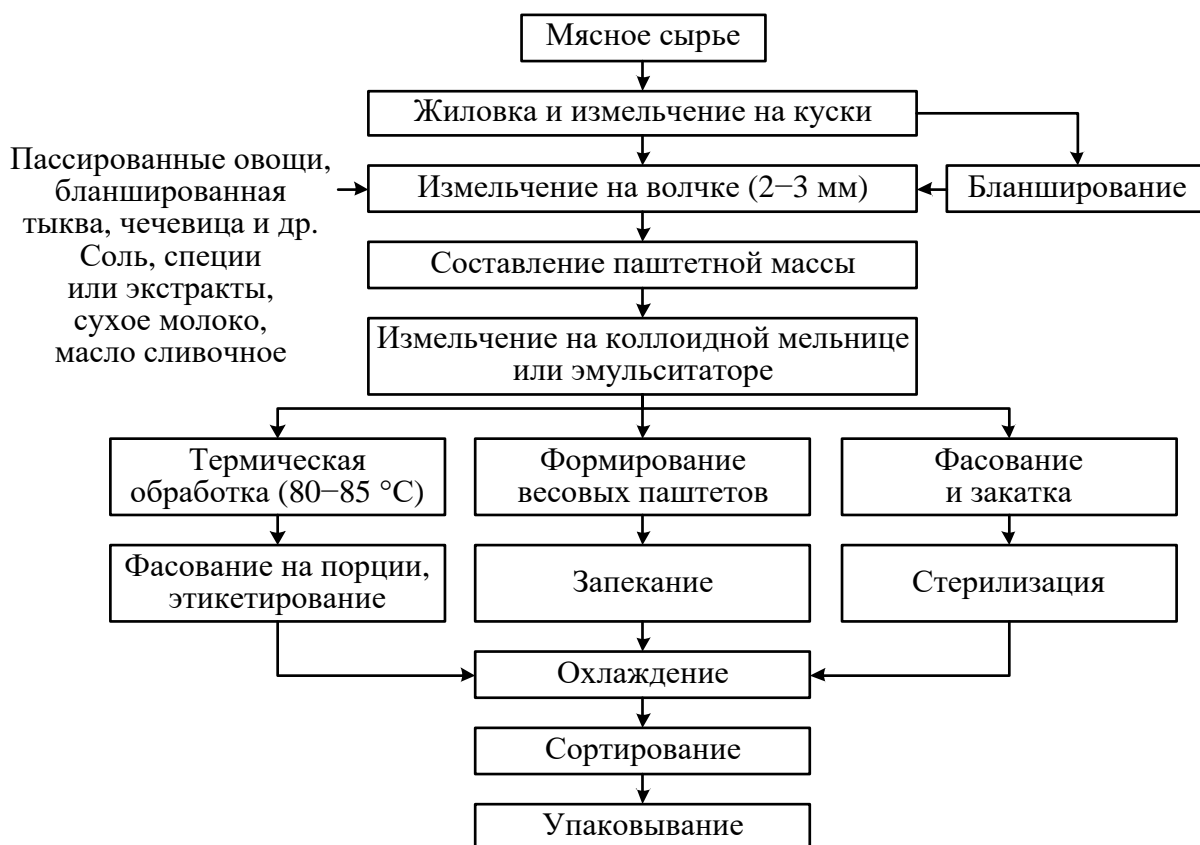
Рисунок 3 – Схема технологического процесса производства паштетов
