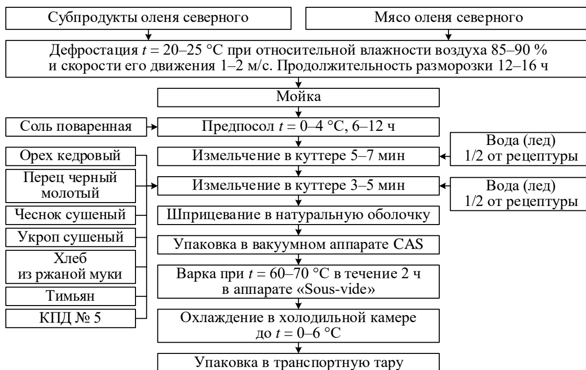
Рисунок 7 – Технологическая схема приготовления мясосодержащих продуктов из арктического сырья
