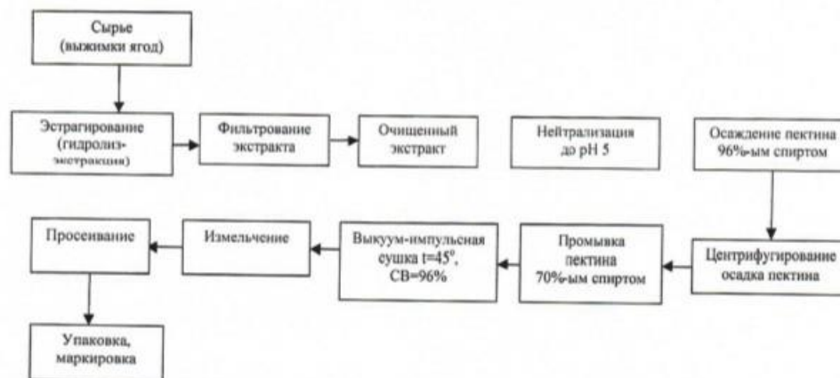
Рисунок 1 – Блок-схема получения ФПИ «Пектин»
