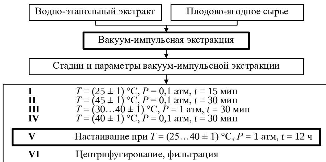
Рисунок 4 – Схема получения экстракта методом вакуум-импульсной экстракции
