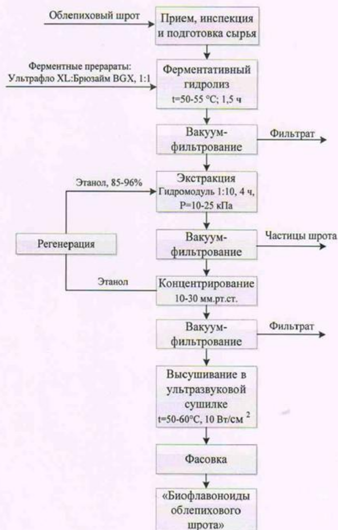
Рисунок 1 – Блок-схема получения Р-витаминной добавки
