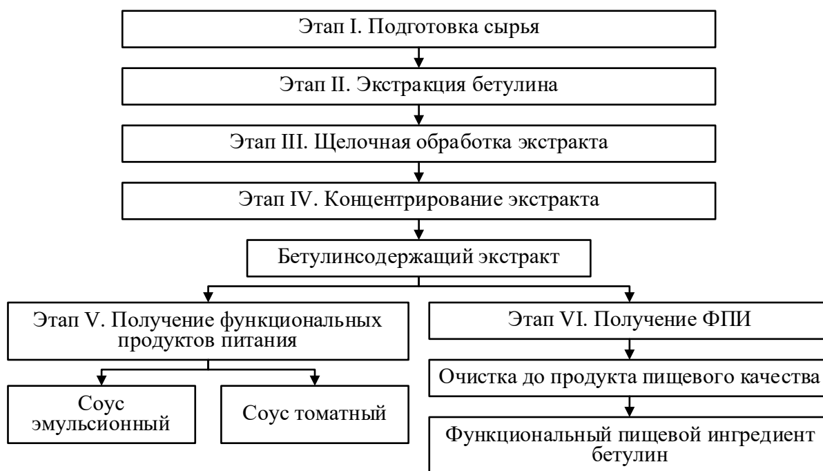
Рисунок 15 – Блок-схема получения бетулинсодержащих продуктов переработки бересты
