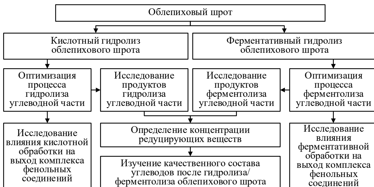
Рисунок 7 – Схема экспериментального исследования по предгидролизу облепихового шрота
