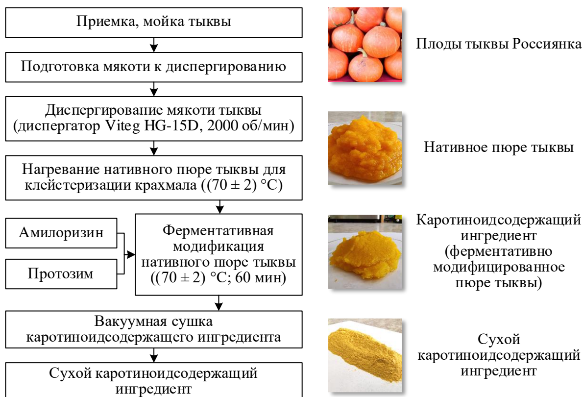
Рисунок 37 – Принципиальная технологическая схема производства сухого каротиноидсодержащего ингредиента
