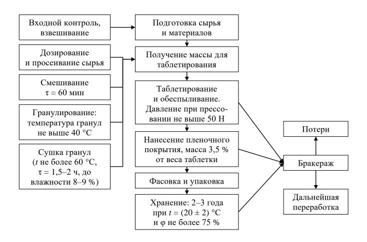
Рисунок 5.1 – Схема технологии производства таблетированной формы БАД «Дискавери Сила Recovery»
