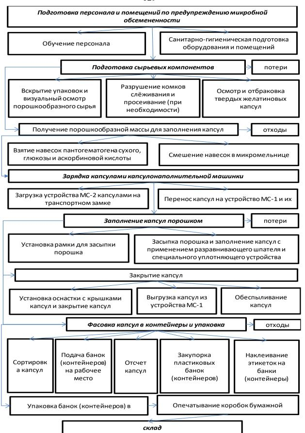
Рисунок 4.3 – Технологическая схема производства БАД «Эргопан Oxygen»
