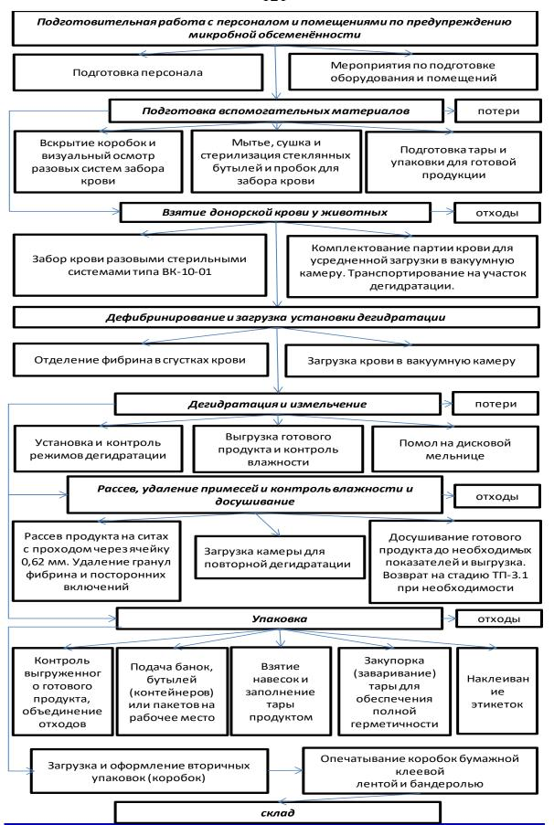
Рисунок 4.1 – Технологическая схема изготовления пантогематогена
