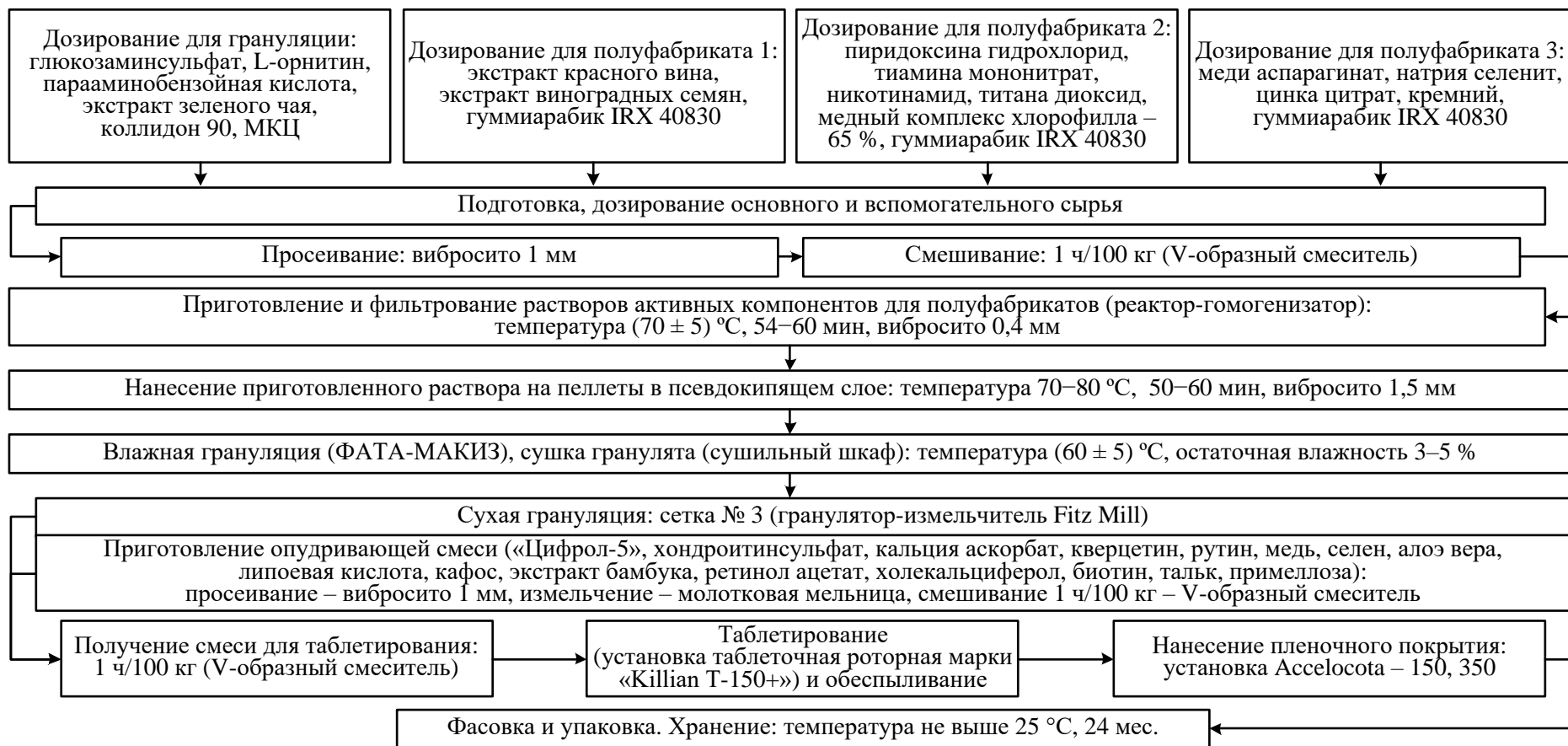
Рисунок 7 – Технологическая схема производства таблетированной формы БАД «Виктория Plus» с использованием пеллетной технологии
