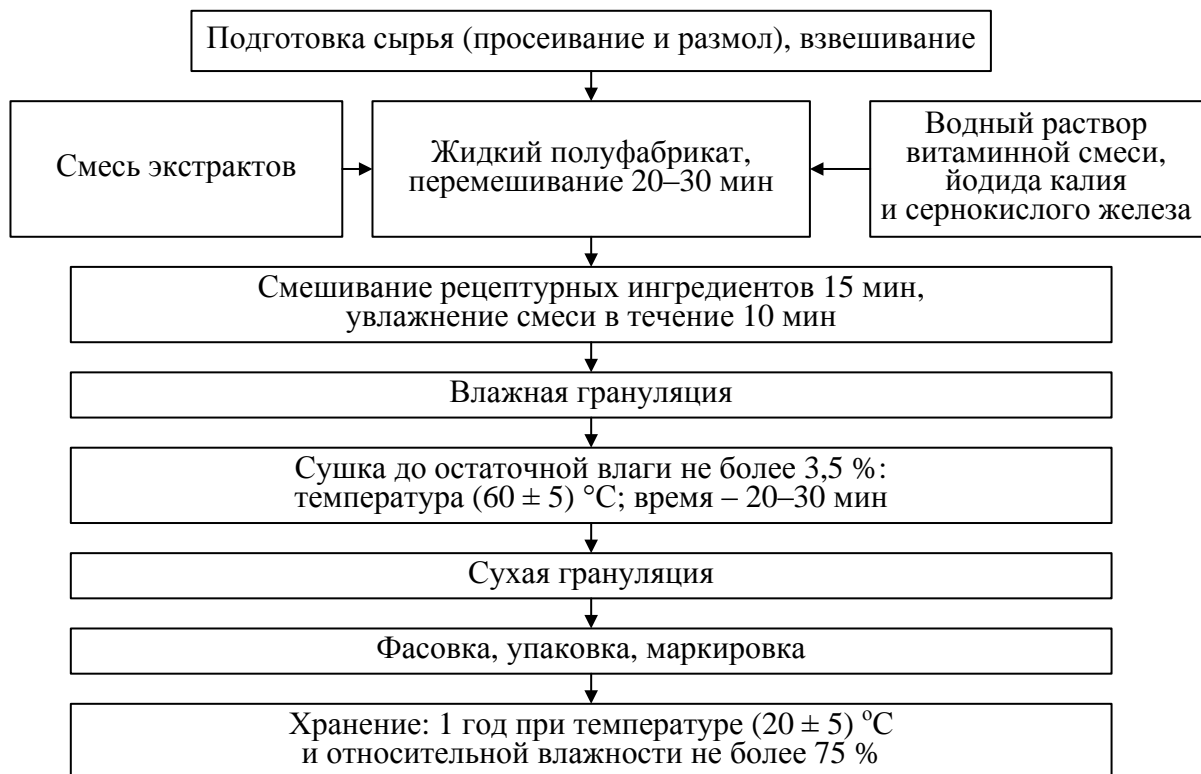
Рисунок 5 – Технологическая схема изготовления сухого напитка, обогащенного витаминами
