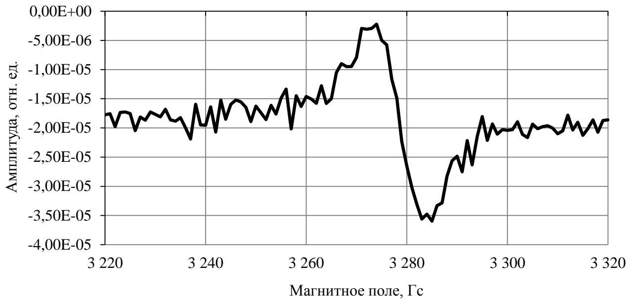
Рисунок 16 – ЭПР-спектр ОКТ форели радужной охлажденной, облученной дозой 3 кГр (g-фактор 2,0047 \pm 0,0001 )
