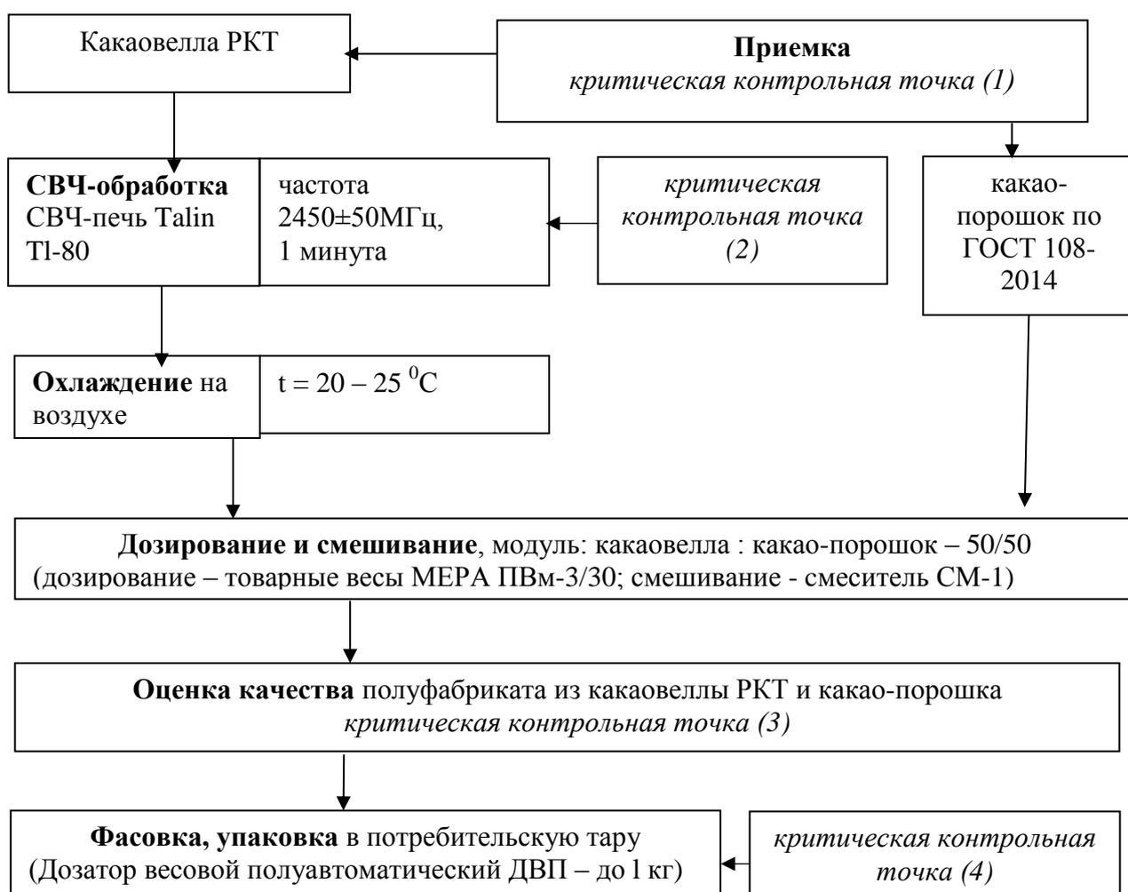
Рисунок 3.19 Технологическая схема технологического процесса производства комплексных порошков из какаоеллы РКТ и какао–порошка
