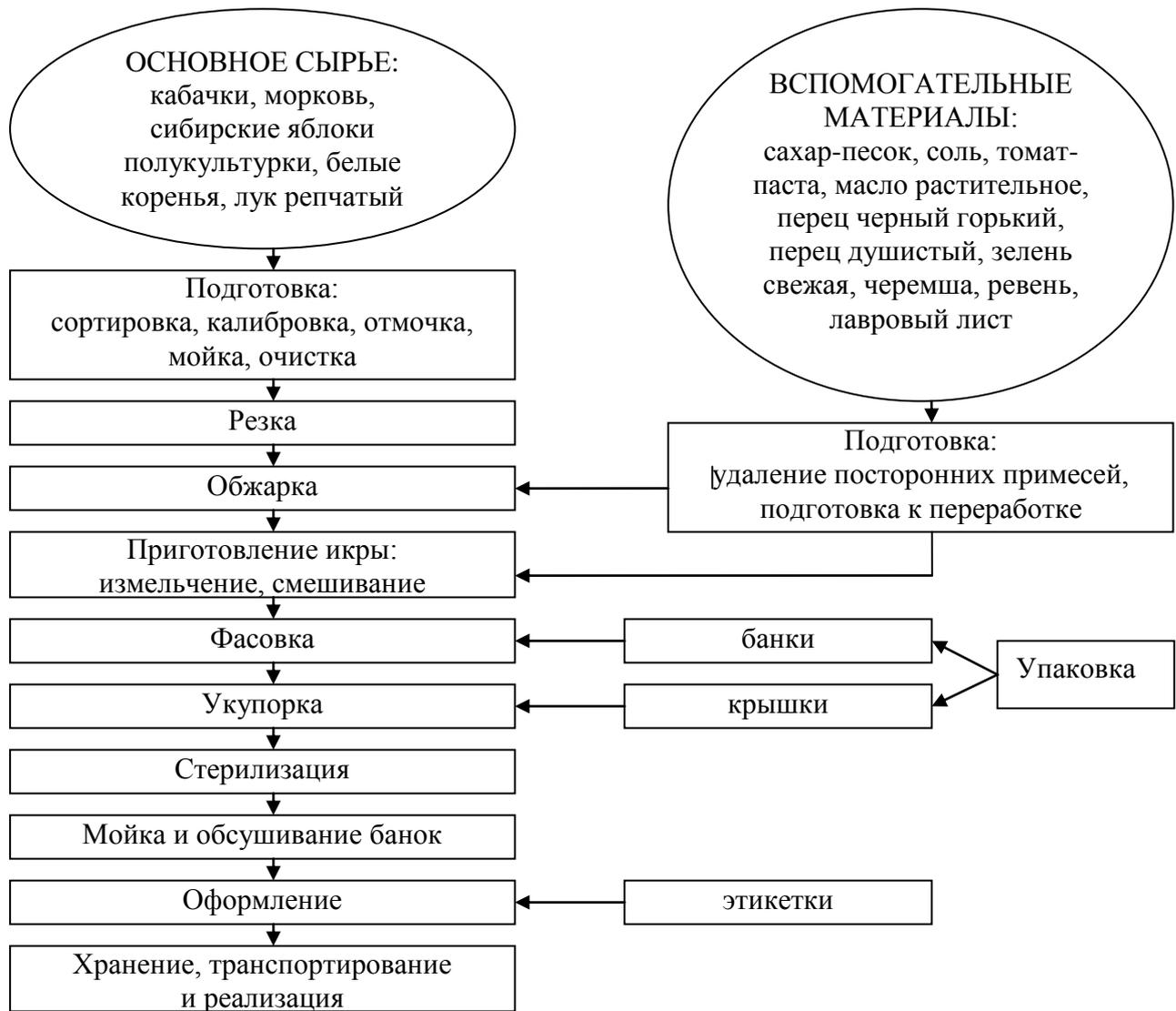
Рисунок 3.10 – Принципиальная технологическая схема производства икры из кабачков с сырьем местного произрастания
